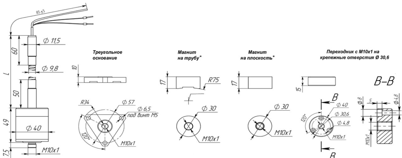
\* - продолжительная эксплуатация магнита допускается при температуре  $t \leq 80^\circ\text{C}$ .
