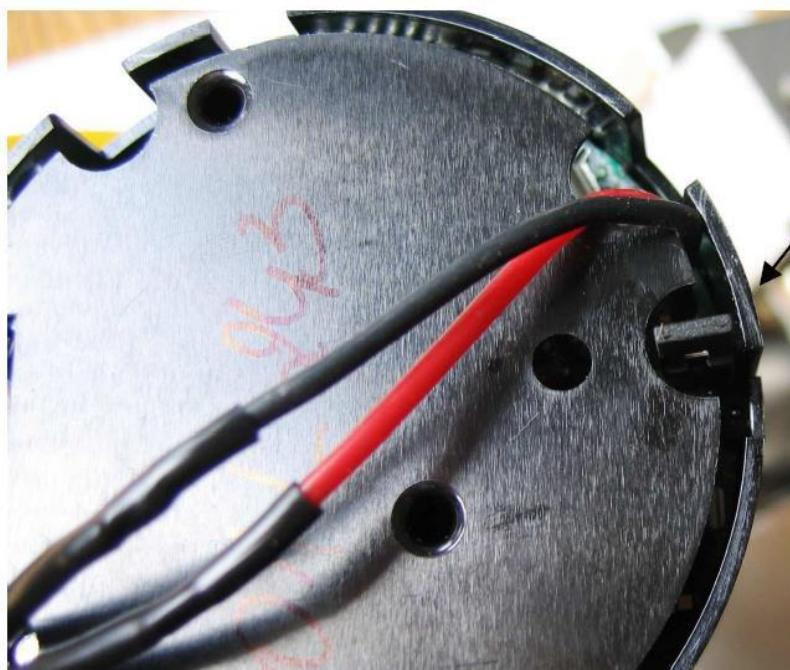
Если перемычка установлена радиально (как на фото) то подсветка дисплея выключена, если перемычка установлена по касательной к окружности корпуса то подсветка дисплея включена
