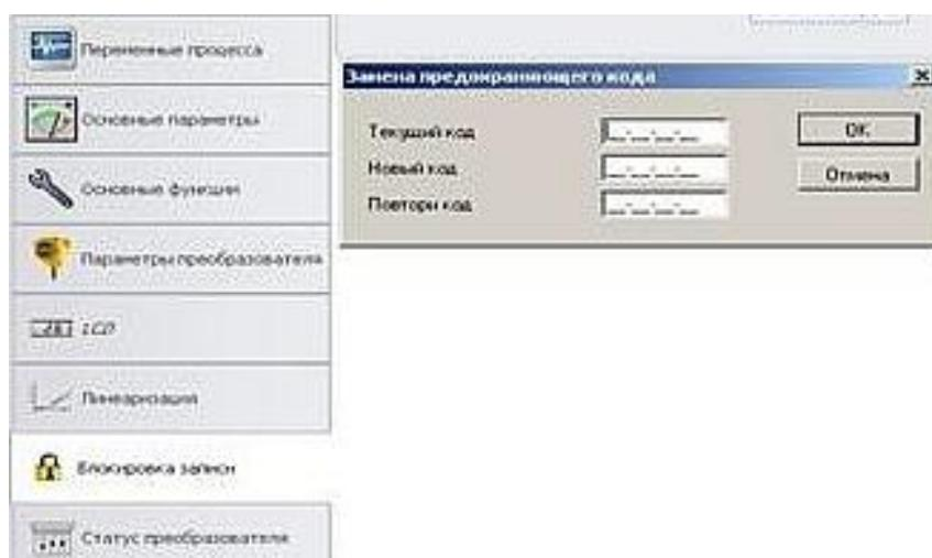
7. В разделе "Блокировка записи", необходимо установить "Состояние блокировки" на "Заблокирован", что сделает невозможным изменение параметров с помощью коммуникации HART.
