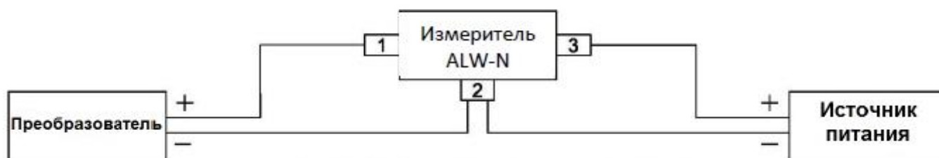
Рис.5. Схема подключения измерителя ALW-N без HART коммуникации
