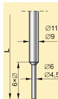
**Специальное исполнение** с редуцированным диаметром защитного корпуса в месте срабатывания чувствительного элемента. Применяется для ускорения динамической характеристики при сохранении механической прочности защитного корпуса в целом.
